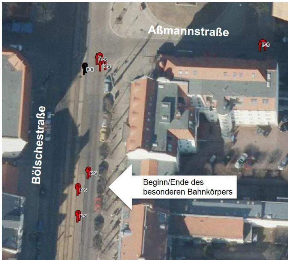
Abbildung 2: Unfälle am KP Aßmannstraße mit Straßenbahnbeteiligung im Luftbild
